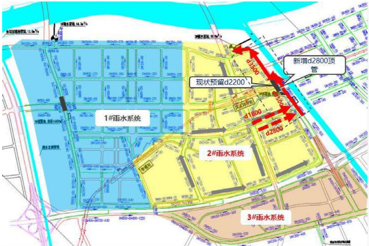
图 2-2-19 雨水系统图方案
