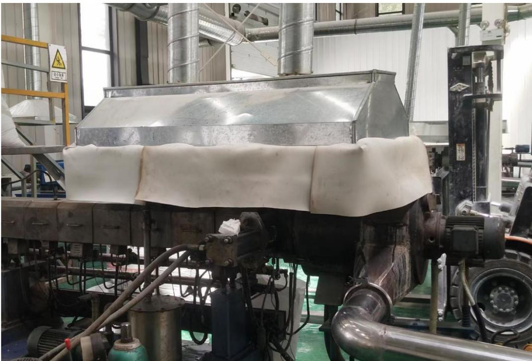
图 3-2 本项目加热熔融工序集气罩及软帘设置情况照片
