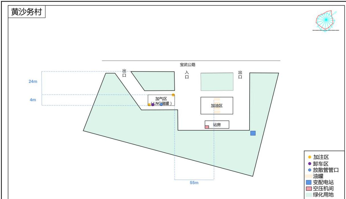
图 3 黄沙务加油站布局示意图
