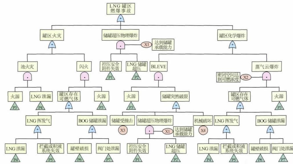
图 14 LNG 罐区燃爆事故树图
