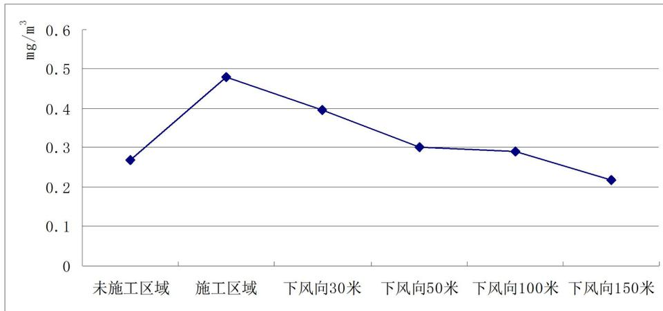
图 12 施工扬尘污染随距离变化图
