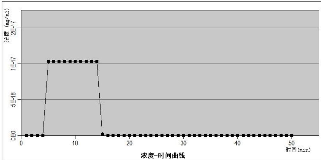
图 16 主导风向下风向环保目标 CO 浓度-时间曲线图
