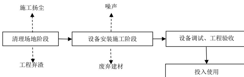
图 10 施工期工艺流程图
