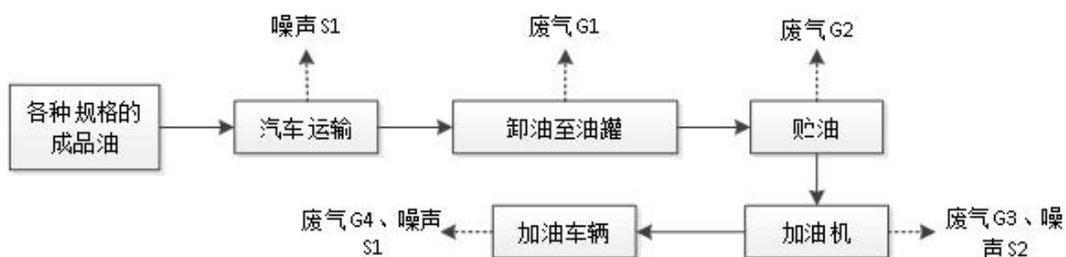
注：S1 车辆噪声；S2 设备噪声；G1 卸油废气（大呼吸废气）；G2 储油废气（小呼吸废气）；G3 加油废气；G4 汽车尾气。
