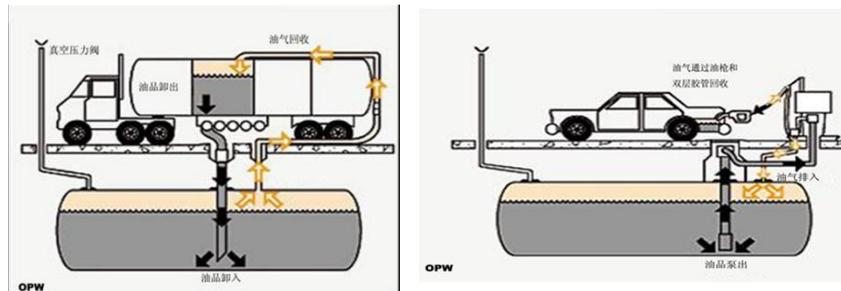
图 7 一次油气回收系统和二次油气回收系统示意图
