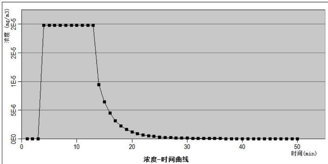
图 15 主导风向下风向环保目标（黄沙务村）天然气浓度-时间曲线图
