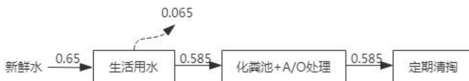
图 5 本项目实施后全厂水平衡图
