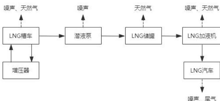
图 11 LNG 加气工艺流程
