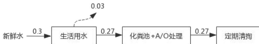
图 4 本项目水平衡图
