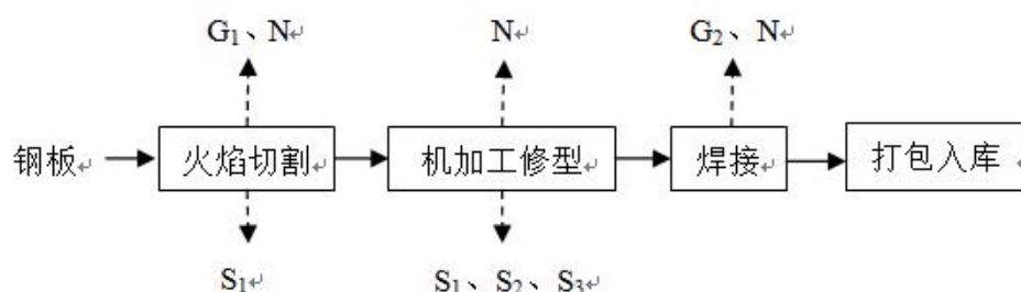
图 2 水箱的生产工艺流程及污染物产生节点示意图
